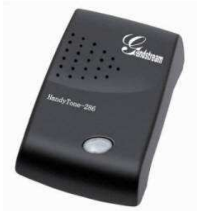
Adaptador ATA que permite que un teléfono analógico se conecte a un sistema VOIP
